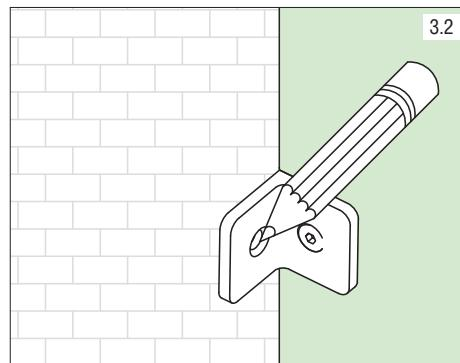
3. Размечаем место крепления неподвижного полотна (2) и коннекторов (14, 15, 18).
