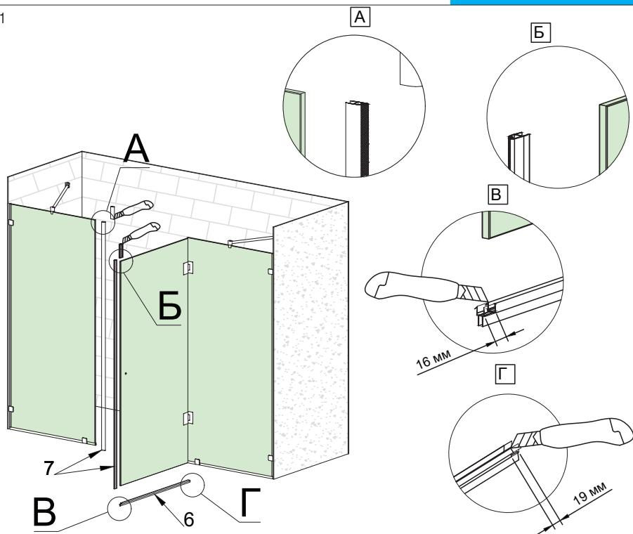
9. Устанавливаем магнитные (7), боковой (9), нижний (6) профили ПВХ и порог (19).
