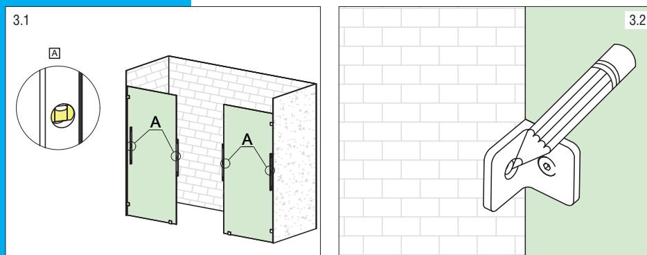
3. Размечаем место крепления неподвижного полотна (2) и (3) и коннекторов (14, 15, 18).
