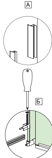
11. Устанавливаем ручку-кнопку (5), герметизируем стыки силиконовым герметиком (в комплект не входит) с внутренней стороны неподвижного полотна (2) к стене и полу.
