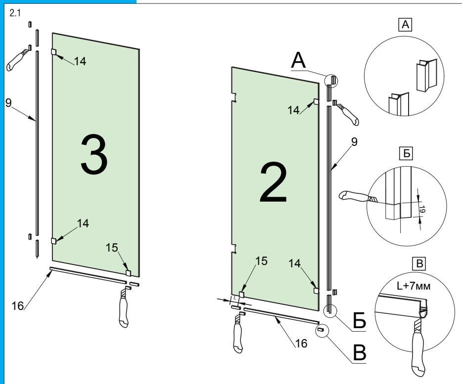
3. Размечаем место крепления неподвижного полотна (2) и (3) и коннекторов (14, 15, 18).
