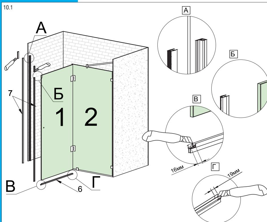
10. Устанавливаем боковой (9) профиль ПВХ и порог (19).
