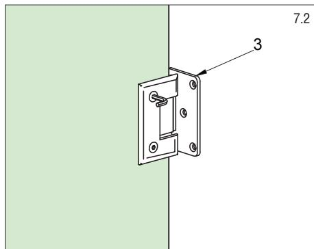
7. Размечаем место крепления петель (3) и крепим дверное полотно (1).
