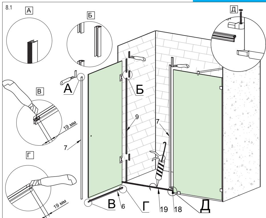
9. Устанавливаем ручку-кнопку (5), герметизируем стыки силиконовым герметиком (в комплект не входит) с внутренней стороны полотна (2) к стене и полу.
