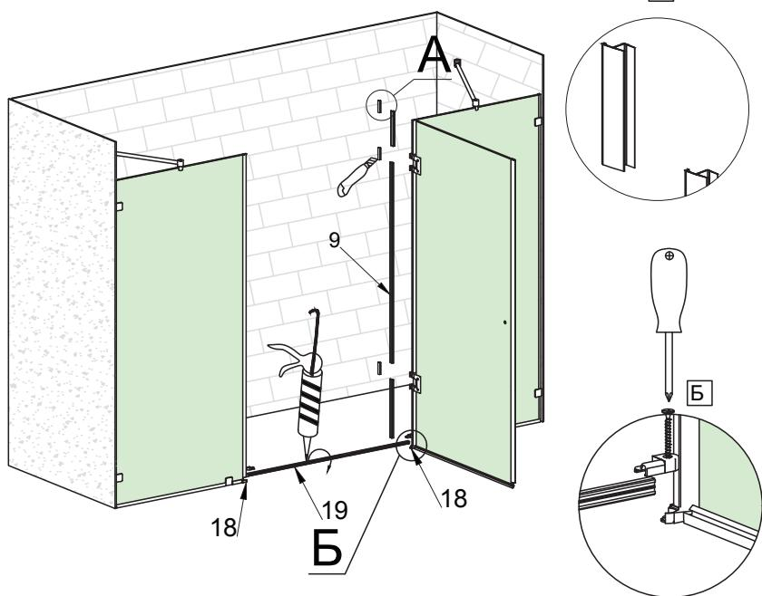
10. Устанавливаем ручку-кнопку (5), герметизируем стыки силиконовым герметиком (в комплект не входит) с внутренней стороны полотна (2) к стене и полу.
