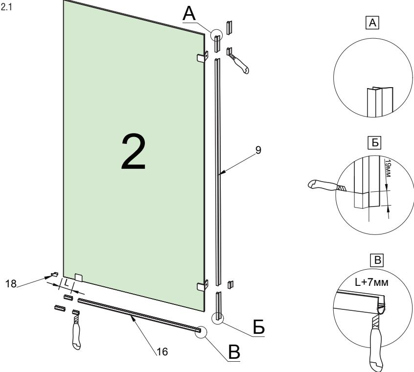
3. Размечаем место крепления неподвижного полотна (2) и коннекторов (14, 15, 18).
