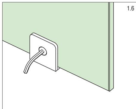
2. Устанавливаем боковой (9), нижний (16) профили ПВХ на стеклянную панель (2).
