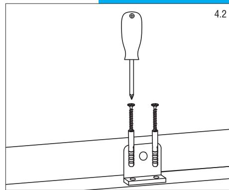
4. Устанавливаем неподвижное полотно (2) и (3), крепим коннектор (18).
