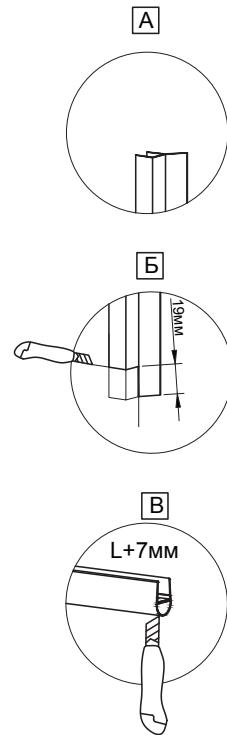
3. Размечаем место крепления неподвижного полотна (2) и коннекторов (14, 15, 18).
