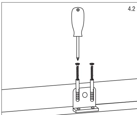
4. Устанавливаем неподвижное полотно (2) и крепим коннектор (18).
