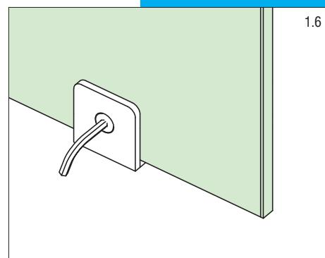
2. Устанавливаем боковой (9), нижний (16) профили ПВХ на стеклянную панель (2) и (3).
